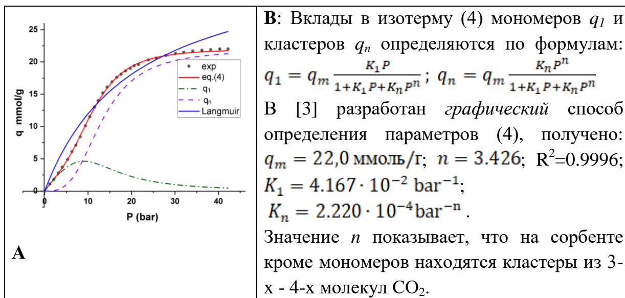
Рис. 1. Адсорбция \text{CO}_2 металл-органическим каркасом IRMOF-1. А: Изотермы адсорбции: точки - эксперимент [4]; линия eq(4) - теоретическая изотерма (4); штрих-пунктир q_1 - вклад в адсорбцию мономеров, пунктир q_n - вклад кластеров; линия Langmuir - изотерма Ленгмюра. В: Характеристики теоретической изотермы (4)
